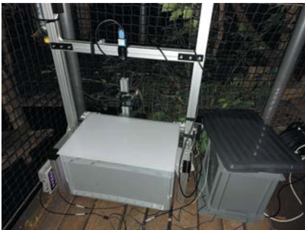
Ein Prototyp eines Fledermausflügelscanners im Manatihäus. Der Scan kann die „Wingprints“, also die Flügelstrukturen an denen die Tiere individuell zu erkennen sind, aufnehmen.
